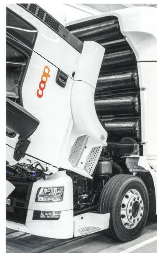
Der mit 350 bar Druck gasförmige Wasserstoff wird in sieben Carbontanks hinter der Kabine gespeichert.
