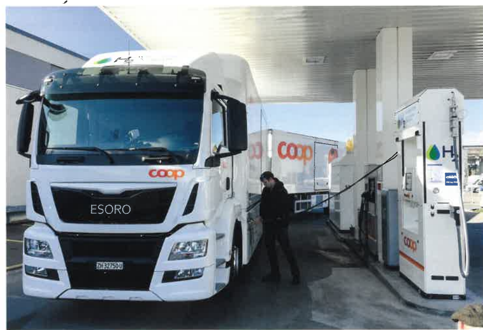
In zehn Minuten ist der Brennstoffzellen-Truck mit Wasserstoff vollgetankt und bereit für die nächste Verteilrunde. Mit Anhänger erreicht der Lastwagen eine Reichweite von bis zu 400 km.
